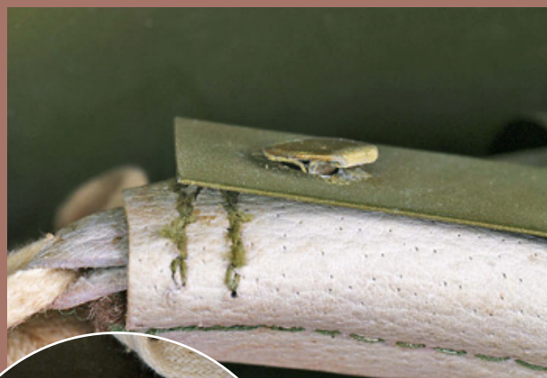
Головки кламмеров крепления лепестков к Т-образным пружинам не осажены, их лапки до конца не разведены. Да и пряжка, оказывается, может располагаться как справа, так и слева (перепутаны половинки подбородочников).
