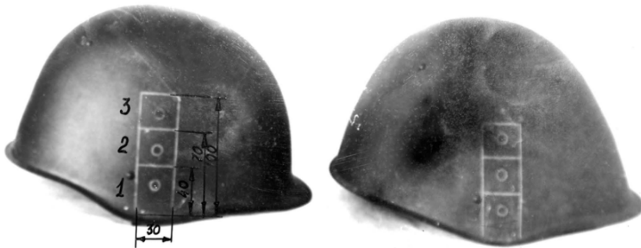
Стальные шлемы СШ-60 и СШ-С с размеченными зачётными зонами на боковой (правой) стороне
